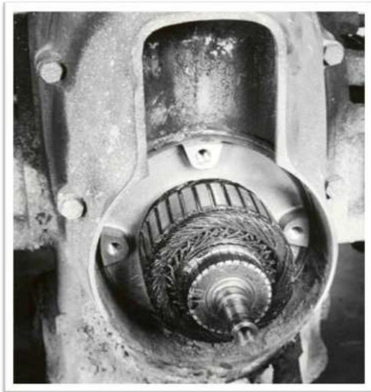
Bild 66: Die Wicklung des Ankers war ziemlich heiss geworden, zeigte aber bei der Nachprüfung einwandfreie Isolationswerte. (F 21/L )
