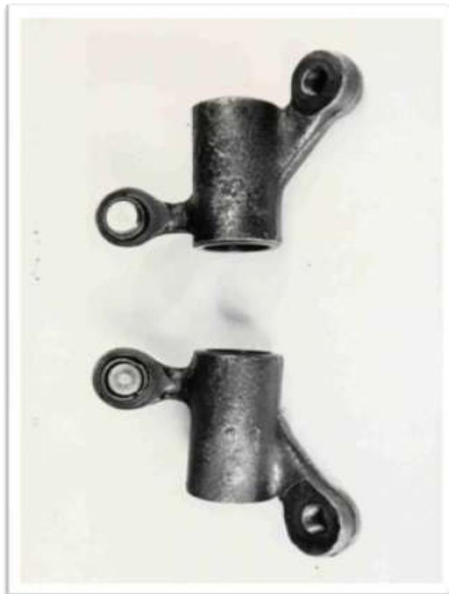
Bild 75: Der Auspuflkipphebel des rechten Zylinders (links) mußte unterwegs ausgewechselt werden, weil die Druckhalbkugel zu tief in der Aussparung saß und die Bördelung am Ventil aufsetzte. Dabei brach der Bördelung aus. ( F 7/L )
