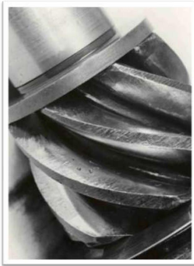
Bild 72: Das Ritzel des Kegelradantriebes hatte auf allen Zähnen hervorragend getragen. Lediglich an einem Zahn war eine geringfügige Pitting-Bildung festzustellen, die aber ohne jeden Einfluss auf die Betriebssicherheit ist.
