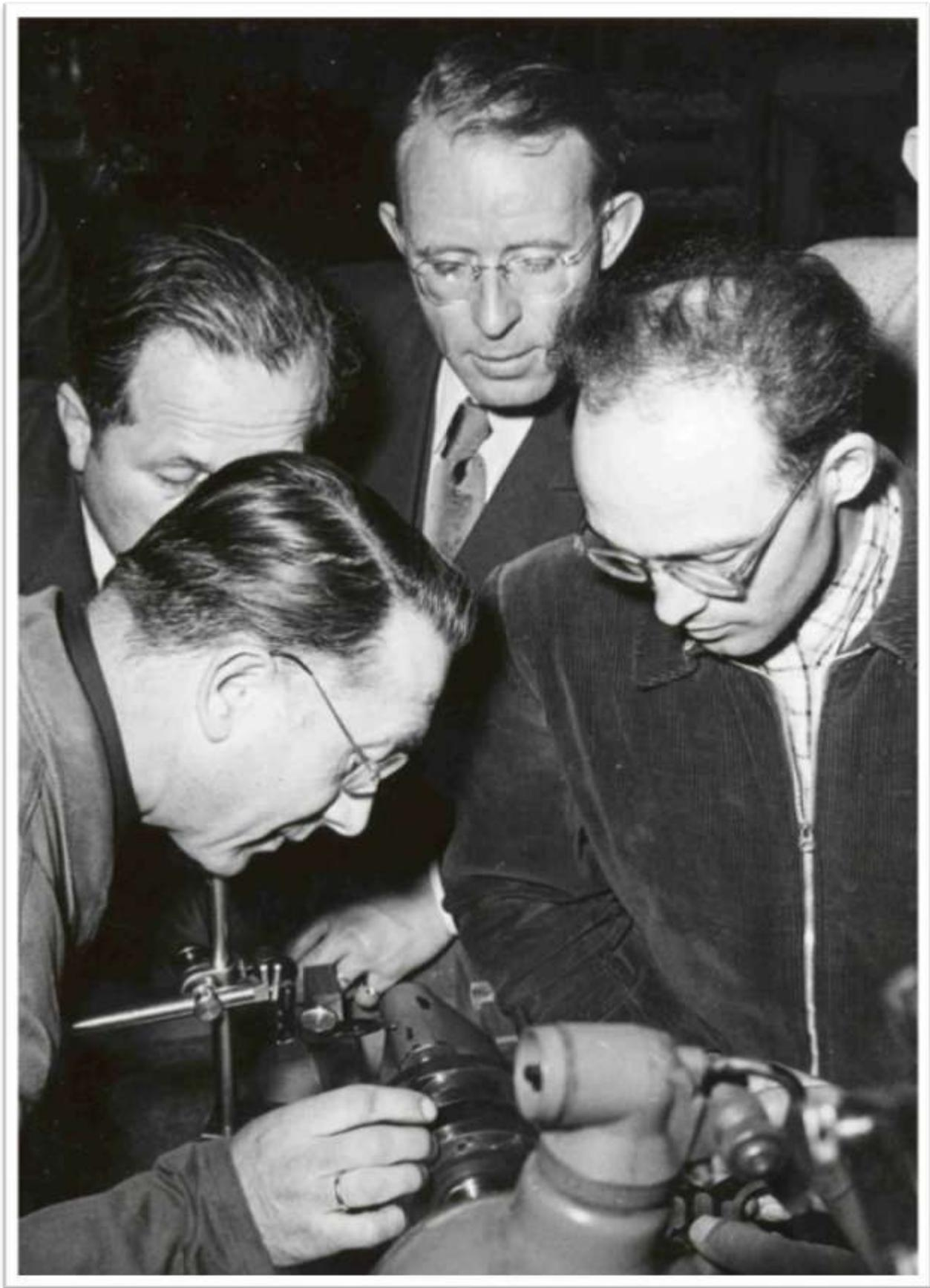
Bild 065: Die zwischen den spitzen laufende Kurbelwelle wird mit einer Batterie von Messuhren auf schlagfreien Lauf überprüft. Der vordere Hauptlagerzapfen zeigte einen Schlag von 0,025 mm, der hintere einen Schlag von 0,007 mm. Der Schlag des Hubzapfens betrug für den vorderen Zapfen 0,04 mm, für den hinteren 0,06 mm. ein Längsspiel der Kurbelwelle konnte nicht festgestellt werden. (F 10-14/L)
