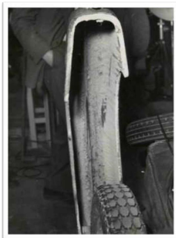
Bild 064: .... bei starken Schlaglöchern bei der hohen Belastung der Reifen am (Seitenwagen) Kotflügel schliff. (F 36/L )
