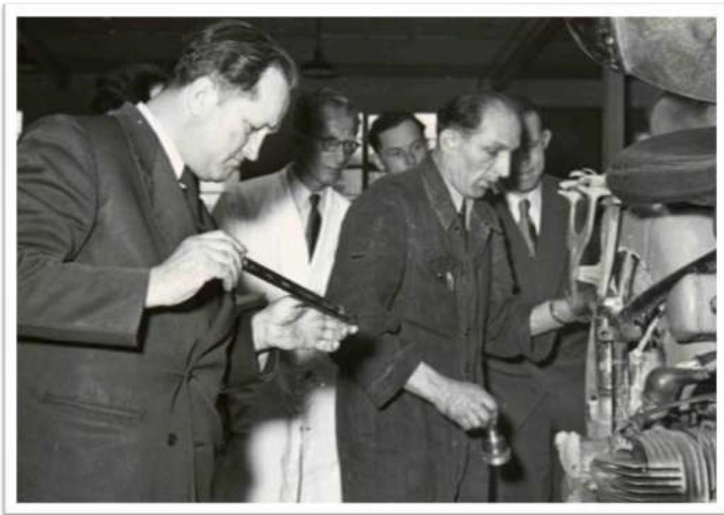
Bild 059: Der Bolzen der Steckachse wurde auf Unrundheit, Abnützung und Schlag geprüft. Der Schlag lag unter 0,05 mm. (F 27/ L)
