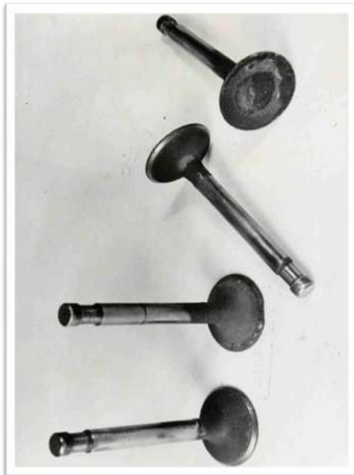
Bild 67: Die Ventile lagen mit ihren Schaftdurchmessern gerade noch an der Grenze der Minustoleranz. Das rechte Auspuffventil, das hier rechts steht, hatte ein zu geringes Spiel und daher auf seinem Sitz nicht einwandfrei gedichtet. Die hindurchpfeifenden Verbrennungs-gase hatten den Sitz verbrannt und
