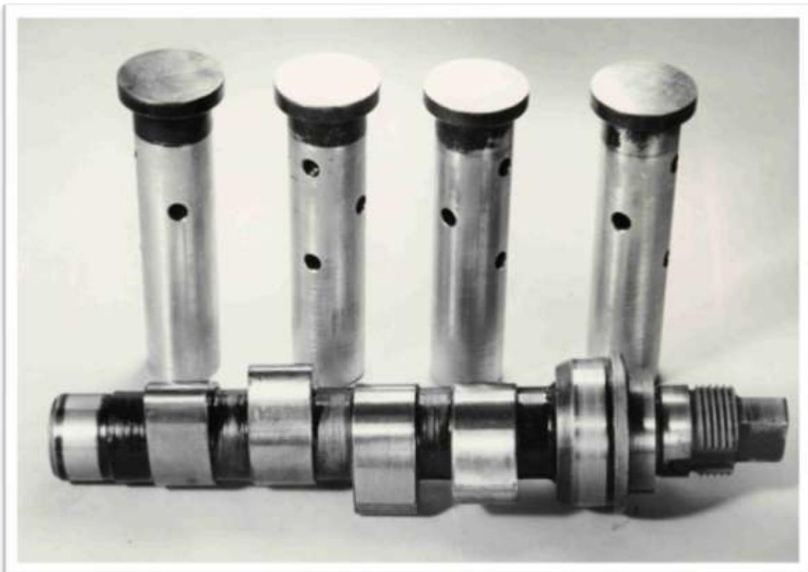
Bild 69: Die Nockenwelle zeigte an den Laufflächen einen hervorragenden Laufspiegel und war praktisch neuwertig. Die Hartgußplatten der Ventilstößel waren durch die Nocken hochglanzpoliert. Mit dem Haarlineal wurde absolute Planheit festgestellt. Die in Gußbüchsen laufenden Leichtmetallschäfte der Ventilstößel zeigen leichte Laufstellen, lassen aber auch im bild noch deutlich die Spuren der Bearbeitung erkennen. Die Stößelschäfte lagen innerhalb der Zeichnungstoleranzen. ( F 8/L )
