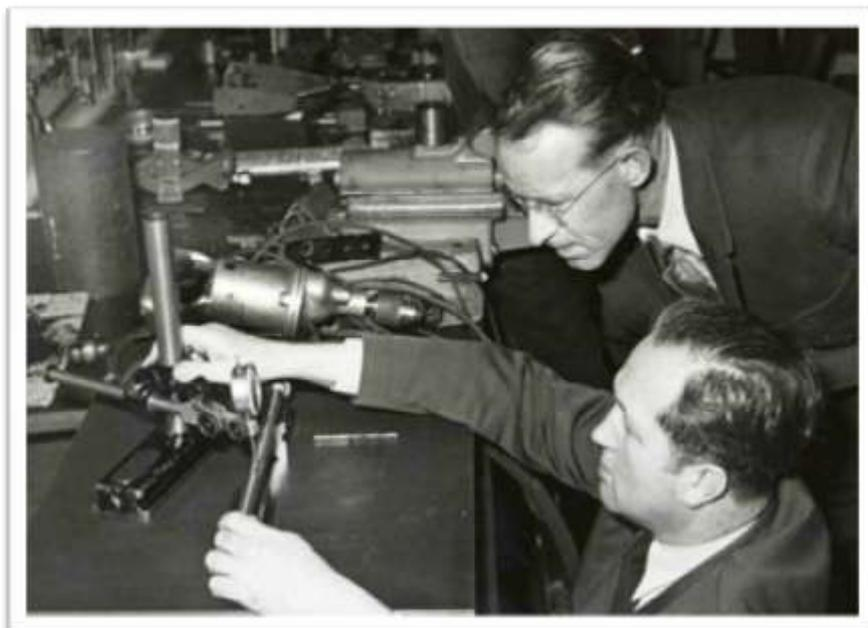
Bild 71: Die Führungsrohre der -Teleskopgabel zeigten nur an den Klemmstellen der unteren Gabelbrücken Markierungen, die H.W.Bönsch hier gerade mit der Messuhr überfährt. Auf den hartverchromten Laufflächen waren über den ganzen Gleitbereich noch die Bearbeitungsriefen sichtbar. Ein Gabelrohr lief ohne jeden Schlag, bei dem anderen wurden 0,03 mm Schlag festgestellt. ( F 28-29/L )
