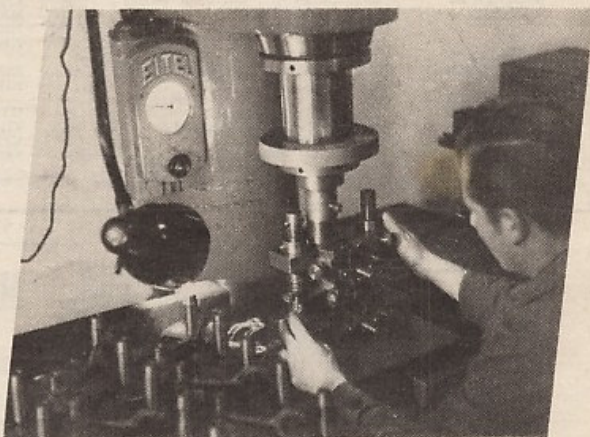
De foto hierboven toont het samenpersen van de twee krukwangen, terwijl men hieronder de machine ziet, die alle gaten tegelijk in het carter boort.
